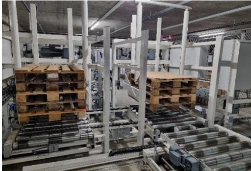
Abbildung 10.15 Leer-Palettenspender für Gutpaletten (1.9.1)
