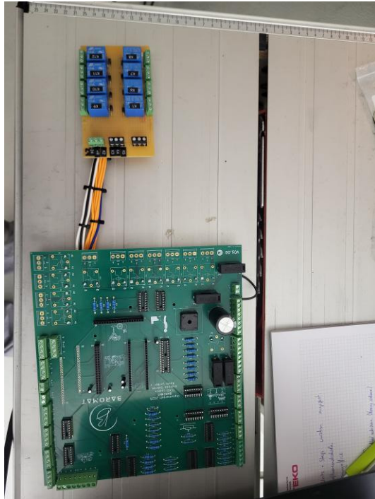
Abbildung 177: 24V Relais und Platine
